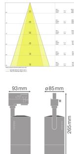
**Scheda tecnica Ledvance Luce a Binario LED D85 Nero 25W 1500lm 15-55D - 830 Luce Calda | Mechanical Zoom - Dimmerabile**
