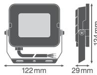
**Scheda tecnica Ledvance Proiettore LED Compatto Nero 20W 2000lm 100D - 865 Luce del Giorno | IP65 - Simmetrico**
