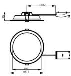
Scheda tecnica Philips Downlight LED Lediniare DN065B Meta Bianca 12W 1200lm 110D - 830-840-865 CCT | 175mm - Ritaglio 150mm - IP20
